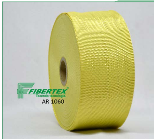
AR 1060 Espessura: 0,80 mm Largura: 60 mm Comprimento do Rolo: 25 m
